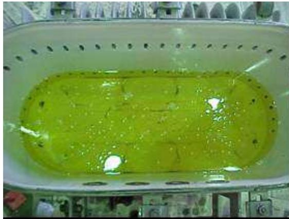
Figura 29 - Vista do Fundo do tanque do transformador, com resíduos desprendidos do núcleo amorfo
