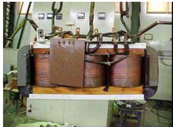
Figuras 34 e 35- Vistas laterais da parte ativa, com as amarrações e fixações da parte ativa, mostrando uma placa de isolamento entre o enrolamento de alta tensão e o tanque
