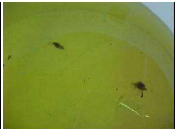
Figuras 23 e 24 - Vista do Fundo do tanque do transformador, com resíduos desprendidos do núcleo amorfo no óleo e pontos de deterioração na pintura causados por atrito da fixação da parte ativa.
