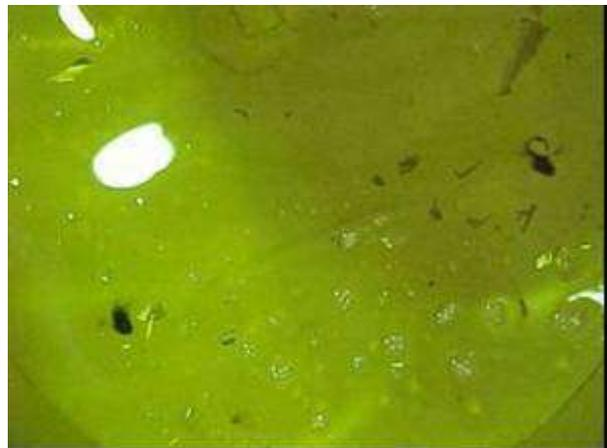
Figuras 36 e 37 - Vista do Fundo do tanque do transformador, com resíduos desprendidos do núcleo amorfo no óleo e pontos de deterioração na pintura causados por atrito da fixação da parte ativa.
