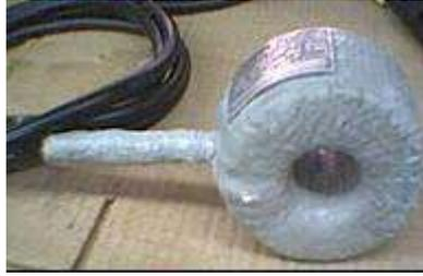
Figura 11 - Aspecto físico do transformador de corrente tipo janela
